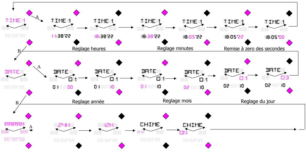
Note: Pour sortir de ce mode: Si l'entrée s'est faite par B attendre 5 secondes ou presser la tige. Si la tige a été tirée : la remettre en place.
